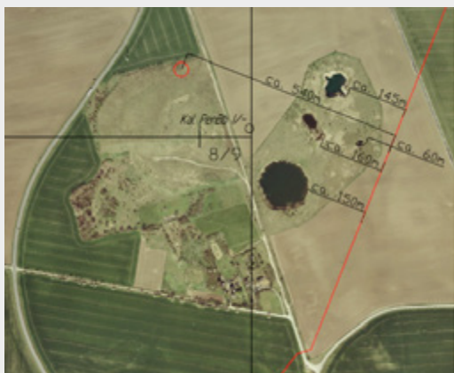
Bild 2: Lage der Ferngasleitung zu den Tagbrüchen
