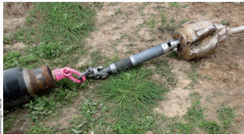
Abb. 1 – Rohr (links) – Zugkraftmessgerät (mitte) – Räumler (rechts)
