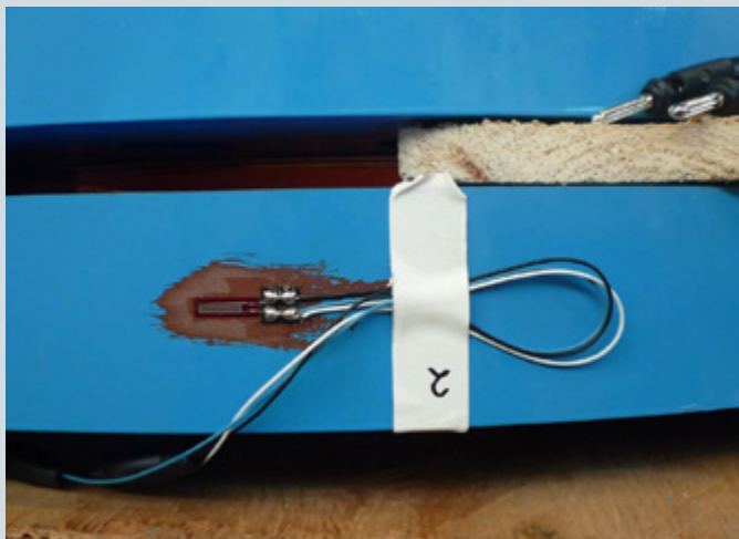
Bild 4: Dehnungsmessstreifen auf Isolierstück
