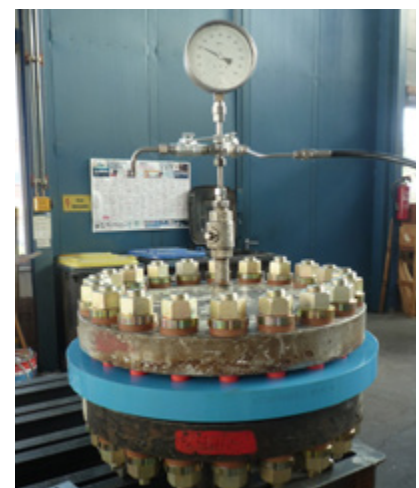
Bild 3: Prüfling mit Blindflanschen
