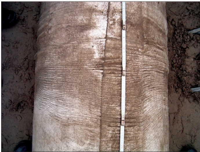
Bild 5: Rohrschutzmatte nach Versuch 4 - Aufkrempelungen
