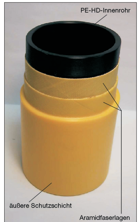
Bild 1: Darstellung eines aramidbewehrten Kunststoffrohres (Werkbild der Firma Wellstream)
